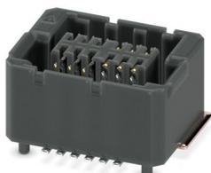
Connecteur femelle SMD, intensité nominale: 1,7 A, Tension d'essai: 500 V AC, nombre de pôles: 12, pas: 0,8 mm, coloris: noir, surface des contacts: Or, type de contact: Connecteur femelle, montage: Sertissage SMD
