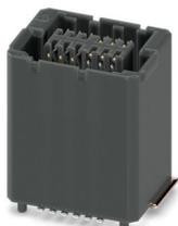
Connecteur femelle SMD, intensité nominale: 1,7 A, Tension d'essai: 500 V AC, nombre de pôles: 12, pas: 0,8 mm, coloris: noir, surface des contacts: Or, type de contact: Connecteur femelle, montage: Sertissage SMD
