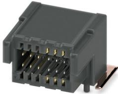
Connecteur mâle SMD, intensité nominale: 1,7 A, Tension d'essai: 500 V AC, nombre de pôles: 12, pas: 0,8 mm, coloris: noir, surface des contacts: Or, type de contact: Mâle, montage: Sertissage SMD
