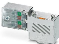
Connecteur mâle D-SUB, 9 pôles, picot, arrivée du câble à 90°, système de bus : PROFIBUS DP jusqu'à 12 MBit/s, résistance de terminaison connectable via commutateur coulissant, brochage : 3, 5, 6, 8 ; raccordement de borne IDC
