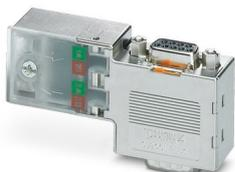
Connecteur mâle D-SUB, 9 pôles, picot, arrivée axiale du câble à 90°, système de bus : PROFIBUS DP jusqu'à 12 MBit/s avec connecteur femelle PG-D-SUB pour raccordement d'un appareil de programmation, résistance de terminaison via commutateur coulissant, brochage : 3, 5, 6, 8 ; blocs de jonction à vis
