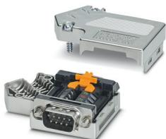
Connecteur mâle D-SUB, 9 pôles, picot, arrivée du câble à 35°, système de bus : PROFIBUS DP jusqu'à 12 MBit/s avec connecteur femelle Pg-D-SUB pour raccordement d'un appareil de programmation, résistance de terminaison via commutateur coulissant, brochage : 3, 5, 6, 8 ; blocs de jonction à vis
