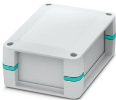
Boîtier complet pour circuit imprimé, fixé au niveau des inserts des montants d'angle, inclut des demi-coques de boîtier, des parois fermées, des inserts de montants d'angle avec support de fixation pour circuit imprimé, des vis pour boîtier et fixation du circuit imprimé, boîtier de couleur gris clair avec inserts de montants d'angle bleu turquoise
