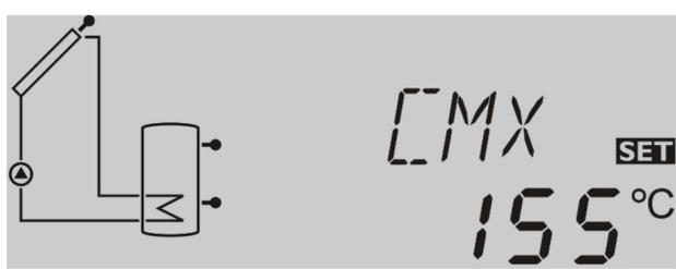
CMX : Température maximale du capteur.
