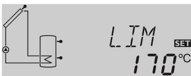
LIM : Température limite du capteur.
