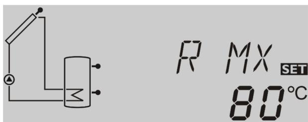
R MX : Température maximale du réservoir.
