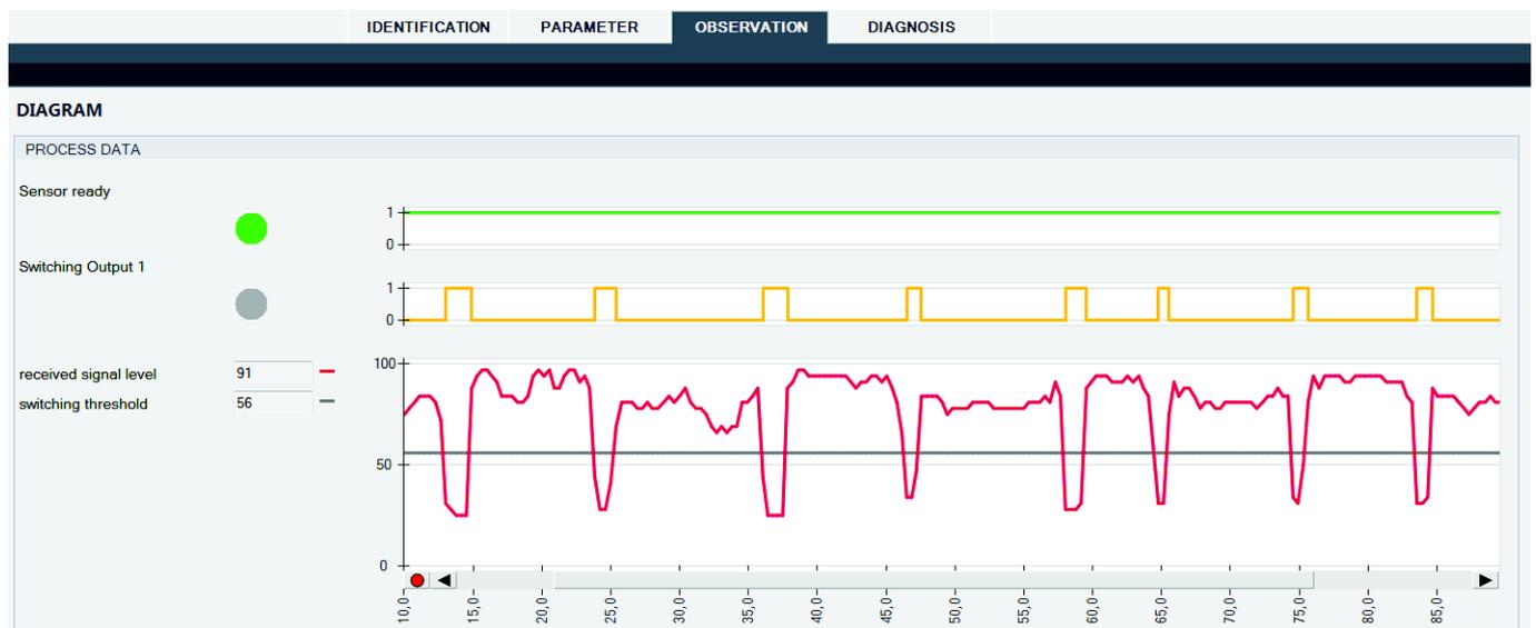
La visualisation simple des données de processus dans le logiciel de paramétrage PC **Sensor Studio de Leuze** permet d'évaluer rapidement la stabilité du processus.
