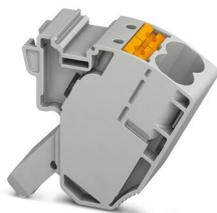
Bloc de jonction de dérivation, tension nominale: 1500 V, intensité nominale: 57 A, nombre de connexions: 2, type de raccordement: Raccordement Push-in, 1er étage, Section de référence: 10 mm<sup>2</sup>, section : 0,5 mm<sup>2</sup> - 16 mm<sup>2</sup>, type de montage: sur embase, coloris: gris
