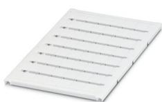
Repères pour blocs de jonction, à commander : sous forme de planche, blanc, impression selon les indications du client, type de montage: encliquetage dans la rainure de repérage élevée, pour bloc de jonction au pas de : 10,2 mm, surface utile: 9,6 x 10,5 mm, Nombre d'étiquettes: 48
