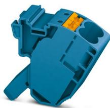
Bloc de jonction de dérivation, tension nominale: 1500 V, intensité nominale: 57 A, nombre de connexions: 2, type de raccordement: Raccordement Push-in, 1er étage, Section de référence: 10 mm<sup>2</sup>, section : 0,5 mm<sup>2</sup> - 16 mm<sup>2</sup>, type de montage: sur embase, coloris: bleu
