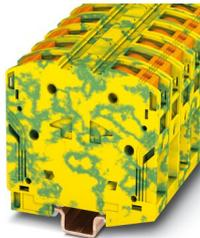
Bloc de jonction pour conducteur de protection, nombre de connexions: 2, nombre de pôles: 1, type de raccordement: Raccordement PowerTurn, 1er étage, Section de référence: 95 mm<sup>2</sup>, section : 25 mm<sup>2</sup> - 95 mm<sup>2</sup>, type de montage: Profilé en cuivre 2,3 mm, coloris: vert/jaune
