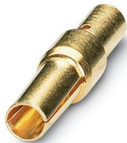
Contact à sertir, Connecteur femelle, tournés, diamètre de contact: 2 mm, zone de sertissage: 1 mm<sup>2</sup> ... 1,5 mm<sup>2</sup>, Produit de remplacement selon RoHS II sans exception 6c (Pb < 0,1 %) référence : 1241635
