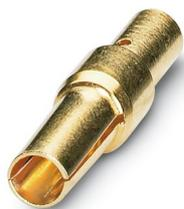
Contact à sertir, Connecteur femelle, tournés, diamètre de contact: 2 mm, zone de sertissage: 1,5 mm<sup>2</sup> ... 2,5 mm<sup>2</sup>, Produit de remplacement selon RoHS II sans exception 6c (Pb < 0,1 %) référence : 1241635
