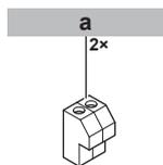
a Connecteurs pour le câble d'interconnexion entre le boîtier optionnel et le boîtier commande EKCB07CAV3.
