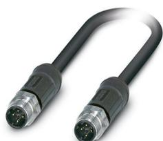
Câble de réseau, Ethernet CAT5 (100 Mbit/s), PROFINET CAT5 (100 Mbit/s), 4-pôles exempt d'halogène, blindé, connecteur mâle droit M12, détrompage: D / IP69K, sur connecteur mâle droit M12, détrompage: D / IP69K, longueur de câble: 2 m, pour applications extérieures, avec molette inox
