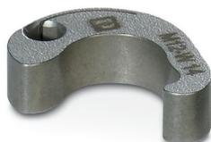
Embout enfichable pour le montage de câbles de capteurs/actionneurs munis de connecteurs M12 et de connecteurs M12 à équiper avec diamètre d'écrou moleté à six pans de 14 mm, pour emmanchement à six pans de 4 mm
