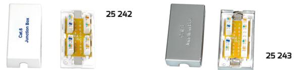
Boitier de jonction CAT6 permettant de raccorder 2 câbles réseau entre eux. S'utilise exclusivement avec du câble monobrin non monté (sans aucun connecteur 8P8C/RJ45 ou autre). Contacts auto-dénudants, connexion avec outil d'insertion page 19. Fixation murale par vis ou adhésif double face.
