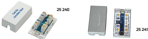
Boitier de jonction CAT5 permettant de raccorder 2 câbles réseau entre eux. S'utilise exclusivement avec du câble monobrin non monté (sans aucun connecteur 8P8C/RJ45 ou autre). Contacts auto-dénudants, connexion avec outil d'insertion page 19. Fixation murale par vis ou adhésif double face.
