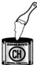
. Vérifier la qualité de la colle , après l'avoir agitée , elle doit couler aisément , ne pas utiliser si elle ne coule pas ou a des grumeaux.
