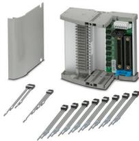
Termination Carrier pour la connexion redondante de 16 amplificateurs-séparateurs analogiques MINI aux cartes d'entrées analogiques de la commande Yokogawa CENTUM VP, via un connecteur KS40, 40 pôles. Compatible avec les cartes Yokogawa AAI143.
