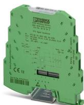
Convertisseur de température configurable pour le raccordement de thermomètres et transmetteurs à résistance à 2, 3 et 4 fils. Configurable par commutateur DIP ou avec la fonctionnalité étendue via le logiciel. Raccordement vissé, configuration standard.
