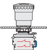
Spécialement conçu pour les boutons coup de poing d'arrêt d'urgence, le contact auto-surveillé permet d'atteindre un niveau d'autocontrôle élevé. Toutes les anomalies éventuelles, comme le détachement du contact du bouton d'arrêt d'urgence, seront immédiatement signalées par l'ouverture du circuit de sécurité. Ainsi, des défaillances difficiles à détecter seront tout de suite mises en évidence.
