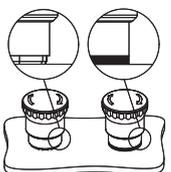
L'anneau façonné peut être utilisé s'il n'y a pas de porte-plaquettes ou d'autres dispositifs, il empêche le dépôt de saleté ou d'autres résidus entre le bouton et le panneau ou le boîtier.
