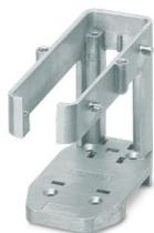
Support de montage pour rail DIN, design : B24, cadre de base, matériau : aluminium moulé sous pression, sans revêtement, rabattable à 180°, pour cadre supérieur HC-CIF-B24-HFFD..., pour rails DIN NS 35/7,5
