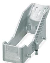
Cadre de montage pour connecteurs HEAVYCONNEC, partie supérieure pour étrier transversal, pour parties inférieures avec étrier transversal HC-CIF...BFWD.. ou pour parties inférieures HC-CIF...BFFD..., pour éléments de contact B24, avec vis M4 à tête à six pans creux de 3 mm, pour profilés NS35/7,5
