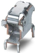
Bloc de jonction pour C.I. pour câbles souples étamés, par ex. de type PV 1-F, intensité nominale : 41 A, nombre de pôles : 1, connectique : raccordement à ressort, montage : THT/THR, informations sur la technologie Through Hole Reflow disponibles sous : [combicon.com](https://www.phoenixcontact.com)
