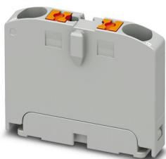
Bloc distributeur, Module de base, tension nominale: 450 V, intensité nominale: 24 A, nombre de connexions: 2, type de raccordement: Raccordement Push-in, section : 0,14 mm<sup>2</sup> - 4 mm<sup>2</sup>, type de montage: encliquetage sur l'adaptateur de profilé, Montage direct avec bride, Volant, coloris: gris
