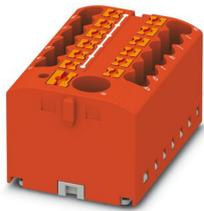
Bloc distributeur, Module de base avec alimentation, tension nominale: 450 V, intensité nominale: 24 A, nombre de connexions: 13, type de raccordement: Raccordement Push-in, Dérivation, section : 0,14 mm<sup>2</sup> - 4 mm<sup>2</sup>, Raccordement Push-in, Raccordement collectif, Section de référence: 6 mm<sup>2</sup>, section : 0,5 mm<sup>2</sup> - 10 mm<sup>2</sup>, type de montage: encliquetage sur l'adaptateur de profilé, Montage direct avec bride, Volant, coloris: rouge
