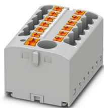
Bloc distributeur, Module de base avec alimentation, tension nominale: 450 V, intensité nominale: 24 A, nombre de connexions: 13, type de raccordement: Raccordement Push-in, Dérivation, section : 0,14 mm<sup>2</sup> - 4 mm<sup>2</sup>, Raccordement Push-in, Raccordement collectif, Section de référence: 6 mm<sup>2</sup>, section : 0,5 mm<sup>2</sup> - 10 mm<sup>2</sup>, type de montage: encliquetage sur l'adaptateur de profilé, Montage direct avec bride, Volant, coloris: gris
