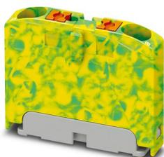
Bloc distributeur, Module de base, tension nominale: 450 V, intensité nominale: 24 A, nombre de connexions: 2, type de raccordement: Raccordement Push-in, section : 0,14 mm<sup>2</sup> - 4 mm<sup>2</sup>, type de montage: encliquetage sur l'adaptateur de profilé, Montage direct avec bride, Volant, coloris: vert/jaune
