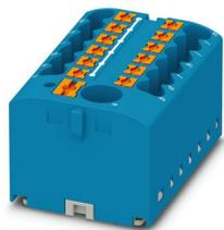
Bloc distributeur, Module de base avec alimentation, tension nominale: 450 V, intensité nominale: 24 A, nombre de connexions: 13, type de raccordement: Raccordement Push-in, Dérivation, section : 0,14 mm<sup>2</sup> - 4 mm<sup>2</sup>, Raccordement Push-in, Raccordement collectif, Section de référence: 6 mm<sup>2</sup>, section : 0,5 mm<sup>2</sup> - 10 mm<sup>2</sup>, type de montage: encliquetage sur l'adaptateur de profilé, Montage direct avec bride, Volant, coloris: bleu
