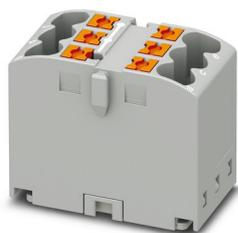
Bloc distributeur, Module de base, tension nominale: 450 V, intensité nominale: 24 A, nombre de connexions: 6, type de raccordement: Raccordement Push-in, section : 0,14 mm<sup>2</sup> - 4 mm<sup>2</sup>, type de montage: encliquetage sur l'adaptateur de profilé, Montage direct avec bride, Volant, coloris: gris
