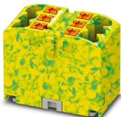
Bloc distributeur, Module de base, tension nominale: 450 V, intensité nominale: 24 A, nombre de connexions: 6, type de raccordement: Raccordement Push-in, section : 0,14 mm<sup>2</sup> - 4 mm<sup>2</sup>, type de montage: encliquetage sur l'adaptateur de profilé, Montage direct avec bride, Volant, coloris: vert/jaune
