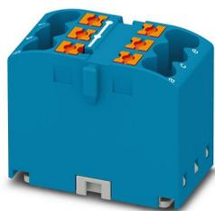
Bloc distributeur, Module de base, tension nominale: 450 V, intensité nominale: 24 A, nombre de connexions: 6, type de raccordement: Raccordement Push-in, section : 0,14 mm<sup>2</sup> - 4 mm<sup>2</sup>, type de montage: encliquetage sur l'adaptateur de profilé, Montage direct avec bride, Volant, coloris: bleu
