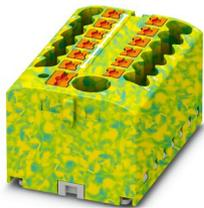
Bloc distributeur, Module de base avec alimentation, tension nominale: 450 V, intensité nominale: 24 A, nombre de connexions: 13, type de raccordement: Raccordement Push-in, Dérivation, section : 0,14 mm<sup>2</sup> - 4 mm<sup>2</sup>, Raccordement Push-in, Raccordement collectif, Section de référence: 6 mm<sup>2</sup>, section : 0,5 mm<sup>2</sup> - 10 mm<sup>2</sup>, type de montage: encliquetage sur l'adaptateur de profilé, Montage direct avec bride, Volant, coloris: vert/jaune
