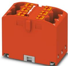
Bloc distributeur, Module de base, tension nominale: 450 V, intensité nominale: 24 A, nombre de connexions: 6, type de raccordement: Raccordement Push-in, section : 0,14 mm<sup>2</sup> - 4 mm<sup>2</sup>, type de montage: encliquetage sur l'adaptateur de profilé, Montage direct avec bride, Volant, coloris: rouge
