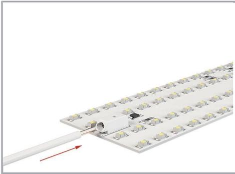
Insertion directe pour raccorder les conducteurs rigides
