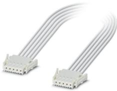
Connecteurs mâles pour C.I. câblés / Câble de connexion avec 2 connecteurs mâles pour C.I., courant de référence: 6 A, longueur de câble: Longueur au choix (0,1 ... 3,0 m), Tête 1: 6-pôles , pas: 2,5 mm , Raccordement à sertir , Connecteur femelle, Coloris: blanc, Type de câble:Toron individuel, PVC, 22 AWG, blanc, Tête 2: 6-pôles, pas: 2,5 mm , Raccordement à sertir , Connecteur femelle, Coloris: blanc, Type de câble:Toron individuel, PVC, 20 AWG, blanc, Toron individuel, PVC, 22 AWG, blanc
