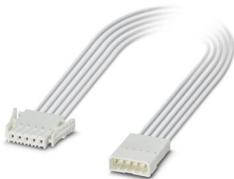
Connecteurs mâles pour C.I. câblés / Câble de connexion avec 2 connecteurs mâles pour C.I., courant de référence: 6 A, longueur de câble: Longueur au choix (0,1 ... 3,0 m), Tête 1: 6-pôles , pas: 2,5 mm , Raccordement à sertir , Connecteur femelle, Coloris: blanc, Type de câble:Toron individuel, PVC, 22 AWG, blanc, Tête 2: 6-pôles, pas: 2,5 mm , Raccordement à sertir , Mâle, Coloris: blanc, Type de câble:Toron individuel, PVC, 20 AWG, blanc, Toron individuel, PVC, 22 AWG, blanc
