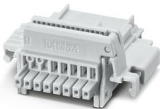
Connecteurs sur profilé, coloris: gris clair, intensité nominale: 6 A, 4 A (contacts parallèles) (Contacts série), tension de référence (III/2): 32 V, nombre de pôles: 8, pas: 2,54 mm, montage: Montage sur profilé, verrouillage: sans, type de fixation: sans, type de conditionnement: emballé dans un carton, Article avec contacts dorés, connecteur de bus pour le raccordement de boîtiers électroniques, 6 contacts parallèles/2 contacts série
