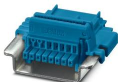
Connecteurs sur profilé, coloris: bleu, intensité nominale: 6 A (contacts parallèles), tension de référence (III/2): 32 V, nombre de pôles: 8, pas: 2,54 mm, montage: Montage sur profilé, verrouillage: sans, type de fixation: sans, type de conditionnement: emballé dans un carton, Article avec contacts dorés, connecteur de bus pour le raccordement de boîtiers électroniques, 8 contacts parallèles
