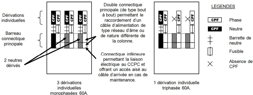
Dans le cas d'une colonne électrique horizontale, le neutre doit être placé en position basse.
