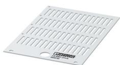
Repères pour câble, Carte, blanc, vierge, repérable avec : BLUEMARK ID COLOR, BLUEMARK ID, THERMOMARK PRIME, THERMOMARK CARD 2.0, THERMOMARK CARD, type de montage: enfilage, plage de diamètre de câble: 1,5 ... 35 mm, surface utile: 23 x 4 mm, Nombre d'étiquettes: 56
