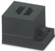
Embout de câble, petit, nombre de conducteurs: 2, version: Câble AS-i (À gauche À gauche), fendu, matériau: NBR, coloris: noir, longueur: 29,5 mm, largeur: 19,5 mm, hauteur: 17 mm
