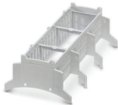
Boîtier électronique sur rail DIN pour l'utilisation dans les répartiteurs d'installation suivant la norme DIN 43880, Partie supérieure du boîtier (U22) avec fentes d'aération, Profondeur de montage de la technique de raccordement : 22,35 mm, largeur: 161,6 mm, hauteur: 89,7 mm, profondeur: 54,85 mm, coloris: gris clair (7035)
