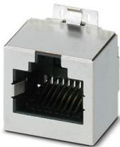
Connecteurs pour circuits imprimés RJ45, type: RJ45, indice de protection: IP20, nombre de pôles: 8, 10 Gbit/s, matériau: Métal, type de raccordement: Par refusion SMD
