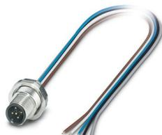
Connecteur d'appareil face arrière, Universel, 5-pôles, Connecteur mâle, droit, M12-Standard, détrompage: A, sur extrémité libre, Montage face arrière, Pg9, Cordons individuels, longueur de câble: 0,5 m, 0,34 mm<sup>2</sup>, Cordon TPE
