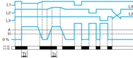
Contrôle de surtension ou de sous-tension en mode fenêtre
