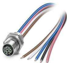
Connecteur d'appareil face arrière, Puissance, 5-pôles, connecteur femelle, droit, M12-Standard, détrompage: L, sur extrémité libre, Montage face arrière, M16 x 1,5, Cordons individuels, longueur de câble: 0,2 m, 2,50 mm<sup>2</sup>, Cordon PEX, Produit de remplacement selon RoHS II sans exception 6c (Pb < 0,1 %) référence : 1239516
