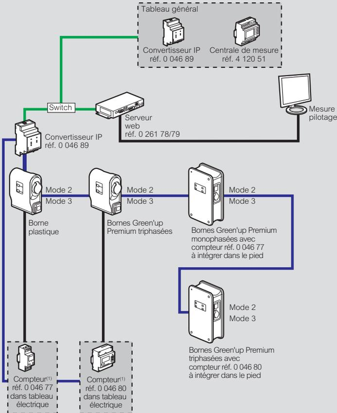
— BUS terrain : câble blindé 4 conducteurs certifié RS 485 (Belden 9842 ou équivalent)
