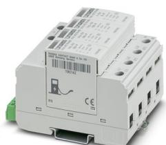
CHARX protect basic, parafoudre enfichable, conforme à type 2 / classe II, pour réseaux électriques triphasés avec conducteurs de neutre et de terre séparés (système à 5 conducteurs : L1, L2, L3, N, PE), avec contact de télésignalisation. Conçu spécialement pour une utilisation dans l'électromobilité.
