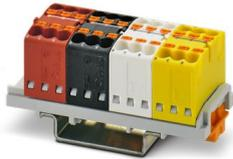
Bloc distributeur, pour bus KNX dans l'installation de bâtiment, bloc individuel avec pontage interne, coloris en fonction du codage de câble EIB, agencement Inline, tension nominale: 500 V, intensité nominale: 17,5 A, nombre de connexions: 24, type de raccordement: Raccordement Push-in, section : 0,14 mm<sup>2</sup> - 2,5 mm<sup>2</sup>, type de montage: NS 15, NS 35/7,5, NS 35/15
