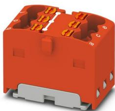
Bloc distributeur, pontage interne, tension nominale: 450 V, intensité nominale: 17,5 A, nombre de connexions: 6, type de raccordement: Raccordement Push-in, section : 0,14 mm<sup>2</sup> - 2,5 mm<sup>2</sup>, type de montage: encliquetage sur l'adaptateur de profilé, Montage direct avec bride, Volant, coloris: rouge
