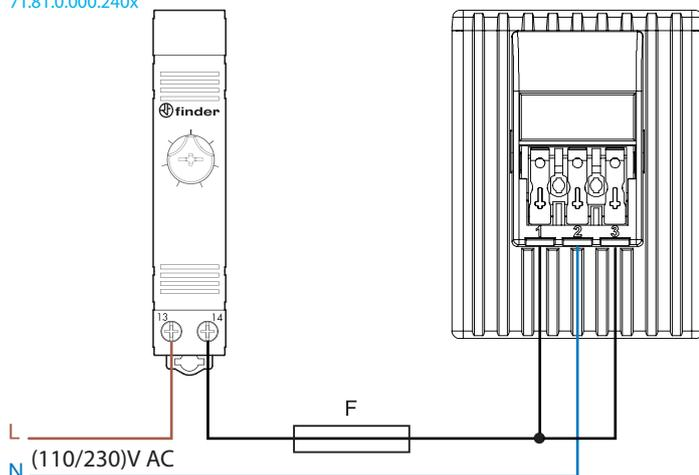
**NOTE :** les bornes d'alimentation (L) pour la résistance et la ventilation peuvent être alimentées de façon indépendante.
