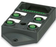
Répartiteur pour capteurs/actionneurs, embase, application : Standard, type de raccordement: Connecteur femelle M12 SPEEDCONNEC Plastique, nombre de prises: 4, nombre de pôles: 4, détrompage: A, affectation des prises: simple, affichage d'état: Oui, pnp; racc. câble multicond.: Raccordement vissé enfichable, blindage: non
