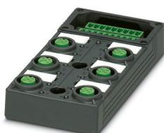
Répartiteur pour capteurs/actionneurs, embase, application : Standard, type de raccordement: Connecteur femelle M12 SPEEDCONNec Plastique, nombre de prises: 6, nombre de pôles: 5, détrompage: A, affectation des prises: double, affichage d'état: Oui, pnp; racc. câble multicond.: Raccordement vissé enfichable, blindage: non
