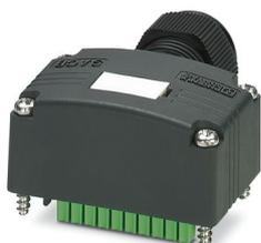
Capot de raccordement avec connecteur mâle intégré, pour répartiteurs pour capteurs/actionneurs M12 avec filetage synthétique SPEEDCONNEC et raccordement vissé enfichable, pour 4, 6 ou 8 emplacements
