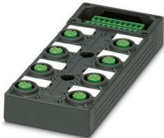
Répartiteur pour capteurs/actionneurs, embase, application : Standard, type de raccordement: Connecteur femelle M12 SPEEDCONNEC Plastique, nombre de prises: 8, nombre de pôles: 4, détrompage: A, affectation des prises: simple, affichage d'état: Oui, pnp; racc. câble multicond.: Raccordement vissé enfichable, blindage: non
