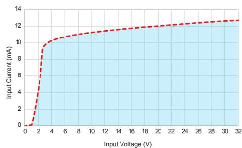
Series GNR contrôle 4-32 V $\overline{\text{DC}}$  (Random)
