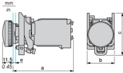
e : épaisseur du dispositif de serrage : 1 à 6 mm / 0,04 à 0,24 pouce
