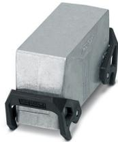
Capot passe-câble B24, avec étrier transversal, matériau: Aluminium coulé sous pression, résistant à l'eau de mer, variable, hauteur: 60 mm, presse-étoupe: sans, Standard, sans trou fileté pour raccordement vissé
