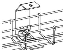
► Possibilité de doubler l'étrier dos à dos pour 2 chemins de câbles larg 50/100 maxi. Fixation par tige fileté (page 92) ou directement au plafond.
