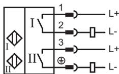
⚠ Le port est indiqué par ⊕ utilisée comme une connexion du capteur et ne doit pas être relié à un conducteur PE.
