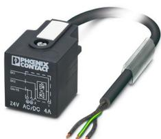
Câble pour capteurs/actionneurs, 3-pôles exempt d'halogène, extrémité libre, sur Connecteur de vanne A, avec 1 LED, câblé avec Diode zéner, longueur de câble: 15 m
