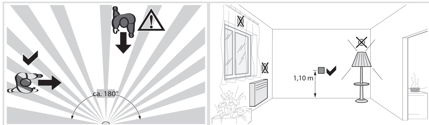
Image 4 : lieu de montage de détecteurs de mouvement et direction du mouvement
