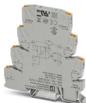
PLC-INTERFACE avec contact de retour, comprenant un module de base avec raccordement Push-in et relais à semi-conducteurs miniature intégré, pour montage sur profilé NS 35/7,5, 1 contact NO, entrée : 24 V DC, sortie : 3-33 V DC/10 A
