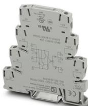
PLC-INTERFACE avec contact inverseur électronique, comprenant un bloc de jonction de base PLC-BSC.../21 avec raccordement vissé et relais statique miniature intégré, pour le montage sur rail DIN NS 35/7,5, 1 contact inverseur, entrée : 24 V DC, sortie : 3 V DC ... 48 V DC/500 mA
