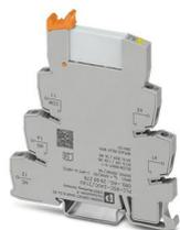
PLC-INTERFACE, comprenant un module de base PLC-BSC.../21 avec raccordement vissé et relais miniature enfichable à contact doré multicouche, pour montage sur profilé NS 35/7,5, 1 contact inverseur, tension d'entrée 24 V AC/DC
