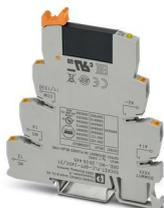
PLC-INTERFACE, comprenant un module de base PLC-BPT.../21 avec raccordement Push-in et relais à semi-conducteurs miniature enfichable, pour montage sur profilé NS 35/7,5, 1 contact NO, entrée : 24 V DC, sortie : 24-253 V AC/0,75 A
