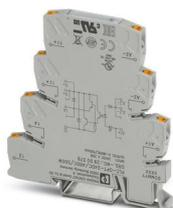
PLC-INTERFACE avec contact inverseur électronique, comprenant un module de base PLC-BPT.../21 avec raccordement Push-in et relais à semi-conducteurs miniature intégré, pour montage sur profilé NS 35/7,5, 1 contact inverseur, entrée : 24 V DC, sortie : 3-48 V DC/500 mA
