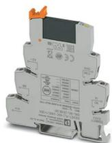
PLC-INTERFACE, comprenant un module de base PLC-BSC.../21 avec raccordement vissé et relais à semi-conducteurs miniature enfichable, pour montage sur profilé NS 35/7,5, 1 contact NO, entrée : 24 V DC, sortie : 24-253 V AC/0,75 A
