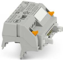
Adaptateur V8 pour 8 x PLC-INTERFACE (6,2 mm), automate: Câblage système API des cartes de sortie, raccordement 1: IDC/FLK connecteur mâle 1x 14-pôles, raccordement 2: Raccord enfichable (Encliquetable sur les 8x blocs de jonction PLC-INTERFACE), raccordement 3: Raccordement vissé 1x 2-pôles, nombre de canaux: 8, logique de commande: minusschaltend
