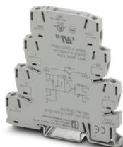
PLC-INTERFACE avec contact de retour, comprenant le bloc de jonction de base avec raccordement vissé et relais à semi-conducteurs miniature enfichable, pour le montage sur rail DIN NS 35/7,5, 1 contact NO, entrée : 24 V DC, sortie : 3 ... 33 V DC/10 A
