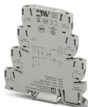
PLC-INTERFACE, relais à semi-conducteurs intégré, avec raccordement vissé, pour montage sur profilé NS 35/7,5, entrée : 24 V DC, sortie : 12-300 V DC/1 A
