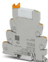
PLC-INTERFACE pour fonctions de sortie, comprenant un module de base PLC-BPT.../ACT avec raccordement Push-in et relais miniature enfichable à contact de puissance, pour montage sur profilé NS 35/7,5, 1 contact NO, tension d'entrée 24 V DC
