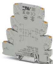
PLC-INTERFACE, relais à semi-conducteurs intégré, avec raccordement Push-in, pour montage sur profilé NS 35/7,5, entrée : 24 V DC, sortie : 12-300 V DC/1 A
