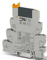
PLC-INTERFACE pour fonctions de sortie, comprenant un module de base PLC-BSC.../ACT avec raccordement vissé et relais à semi-conducteurs miniature enfichable, pour montage sur profilé NS 35/7,5, 1 contact NO, entrée : 24 V DC, sortie : 3-33 V DC/3 A
