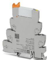
Interface PLC, comprend l'embase PLC-BSC.../21 avec connexion vissée et un relais miniature enfichable à contact de puissance, se monte sur profilé NS 35/7,5, 1 inverseur, tension d'entrée 24 V DC
