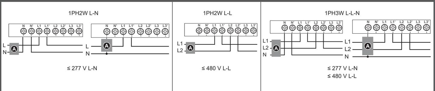
**1PH multiple load with N / Carga múltiple de 1F con N / 1PH charge multiple avec N / 1PH mehrere Verbraucher mit N / 1F carico multiplo con N / 1F carga múltipla com N / 1Ф на много нагрузок с нейтралью / 多负载单相加中性线**
