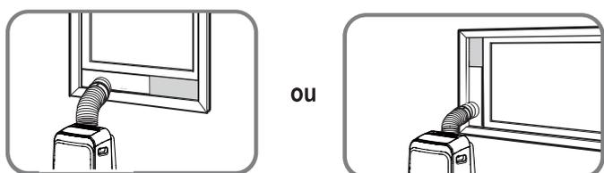
5. Insérez l'adaptateur de curseur de fenêtre dans le trou du curseur de fenêtre.
