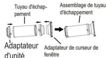
Deuxième étape: Installer l'assemblage de tuyau d'échappement à l'appareil
