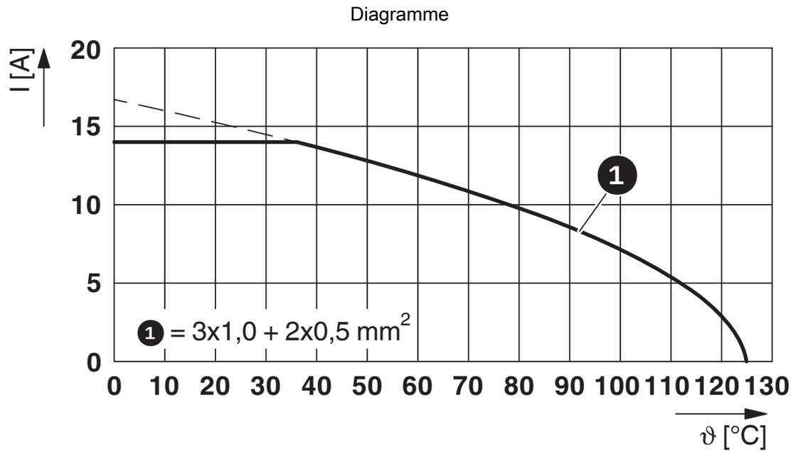
$I$  = intensité,  $\vartheta$  = température ambiante, 3 x 14 A + 2 x 2 A stables
