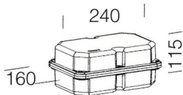
cassetta stagna in nylon. Contenente trasformatore elettromeccanico e morsettiera.
