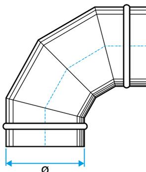
Schéma d'encombrement Coude 90° en aluminium
