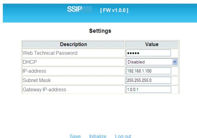
Modificare opportunamente la configurazione di rete del dispositivo. Cambiare infine la password web installatore predefinita (campo: Web Technical Password).
