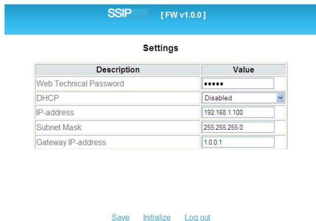
Измените сетевую конфигурацию устройства надлежащим образом. Измените веб-пароль установщика по умолчанию (поле: веб-пароль установщика).
