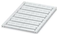
Repères pour blocs de jonction, Planche, blanc, vierge, repérable avec : TOPMARK NEO, LASER TOPMARK, BLUEMARK ID COLOR, BLUEMARK ID, BLUEMARK CLED, THERMOMARK PRIME, THERMOMARK CARD 2.0, THERMOMARK CARD, type de montage: encliquetage, pour bloc de jonction au pas de : 10,2 mm, surface utile: 9,4 x 4,7 mm, Nombre d'étiquettes: 36
