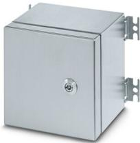
Boîtier vide, matériau: Acier inoxydable 316L / 1.4404, résistance superficielle: brossée, argenté, 400 mm x 300 mm x 160 mm, type de verrouillage: Porte avec charnière amovible, fournitures - ATD: Charnière de porte avec bouchon quart de tour, Plaque de montage, Clé à double panneton, Équerre de fixation avec vis de montage, Boulon de mise à la terre M12 positionné sur la face extérieure, Instructions d'installation, Charnière de porte avec bouchon quart de tour
