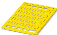
Repère pour conducteur, Planche, jaune, vierge, repérable avec : BLUEMARK ID COLOR, BLUEMARK ID, BLUEMARK CLED, PLOTMARK, CMS-P1-PLOTTER, type de montage: insertion, plage de diamètre de câble: 0,6 ... 7 mm, surface utile: 10 x 4 mm, Nombre d'étiquettes: 48
