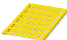
Repère pour conducteur, Planche, jaune, vierge, repérable avec : TOPMARK NEO, LASER TOPMARK, BLUEMARK ID COLOR, BLUEMARK ID, BLUEMARK CLED, THERMOMARK PRIME, THERMOMARK CARD 2.0, THERMOMARK CARD, type de montage: insertion, plage de diamètre de câble: 0,6 ... 7 mm, surface utile: 10 x 4 mm, Nombre d'étiquettes: 60
