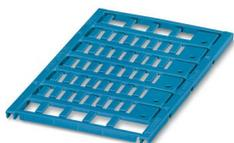
Repère pour conducteur, Planche, bleu, vierge, repérable avec : BLUEMARK ID COLOR, BLUEMARK ID, BLUEMARK CLED, PLOTMARK, CMS-P1-PLOTTER, type de montage: insertion, plage de diamètre de câble: 0,6 ... 7 mm, surface utile: 10 x 4 mm, Nombre d'étiquettes: 48
