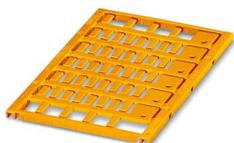
Repère pour conducteur, Planche, orange, vierge, repérable avec : BLUEMARK ID COLOR, BLUEMARK ID, BLUEMARK CLED, PLOTMARK, CMS-P1-PLOTTER, type de montage: insertion, plage de diamètre de câble: 0,6 ... 7 mm, surface utile: 10 x 4 mm, Nombre d'étiquettes: 48
