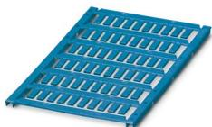
Repère pour conducteur, Planche, bleu, vierge, repérable avec : TOPMARK NEO, LASER TOPMARK, BLUEMARK ID COLOR, BLUEMARK ID, BLUEMARK CLED, THERMOMARK PRIME, THERMOMARK CARD 2.0, THERMOMARK CARD, type de montage: insertion, plage de diamètre de câble: 0,6 ... 7 mm, surface utile: 10 x 4 mm, Nombre d'étiquettes: 60
