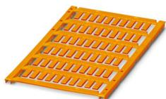
Repère pour conducteur, Planche, orange, vierge, repérable avec : TOPMARK NEO, LASER TOPMARK, BLUEMARK ID COLOR, BLUEMARK ID, BLUEMARK CLED, THERMOMARK PRIME, THERMOMARK CARD 2.0, THERMOMARK CARD, type de montage: insertion, plage de diamètre de câble: 0,6 ... 7 mm, surface utile: 10 x 4 mm, Nombre d'étiquettes: 60
