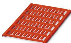
Repère pour conducteur, Planche, rouge, vierge, repérable avec : TOPMARK NEO, LASER TOPMARK, BLUEMARK ID COLOR, BLUEMARK ID, BLUEMARK CLED, THERMOMARK PRIME, THERMOMARK CARD 2.0, THERMOMARK CARD, type de montage: insertion, plage de diamètre de câble: 0,6 ... 7 mm, surface utile: 10 x 4 mm, Nombre d'étiquettes: 60
