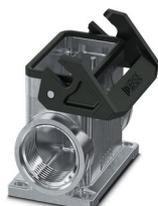
Embase en saillie B10, avec étrier longitudinal, matériau: Aluminium coulé sous pression, résistant à l'eau de mer, nombre de sorties: 2, latérale, 2x M32, hauteur: 74,5 mm, presse-étoupe: sans, Standard
