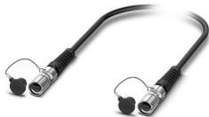
Série M17 avec assemblage de connecteurs à fibre optique préconfectionné : connecteur mâle-connecteur mâle 4 pôles, fibre de verre multimode G62.5/125 µm OM1 à raccordement vissé, longueur du câble fibre optique : 190 m, indice de protection IP67 après insertion, installation fixe dans des goulottes, des goulottes souterraines et des tubes de protection de câbles pour une utilisation en intérieur et en extérieur
